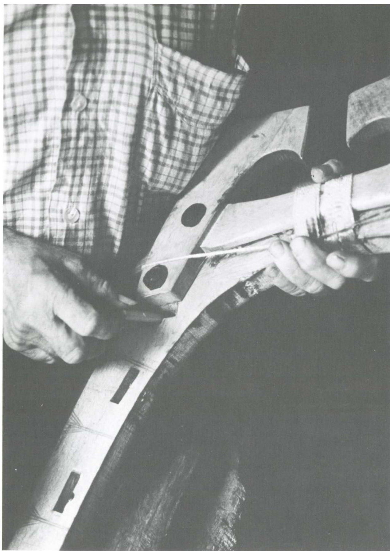
Ο κύρ Βαγγέλης χρησιμοποιεί καβίλιες αντί για καρφιά.
