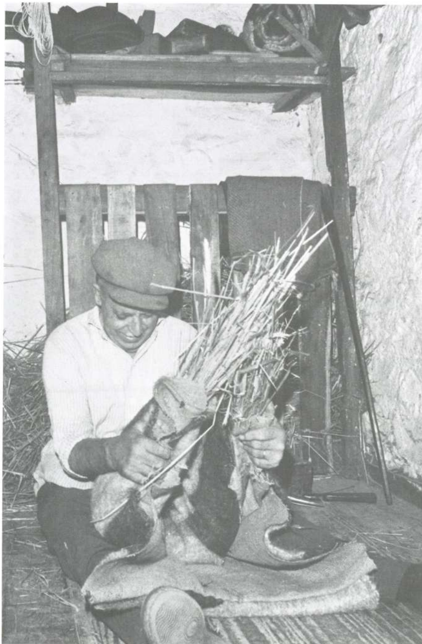
Ὁ σαμαράς σπάει τὰ κοτσάνια γιά νά δώσει στήν κολάτσα τὴν καμπύλη μορφή.
