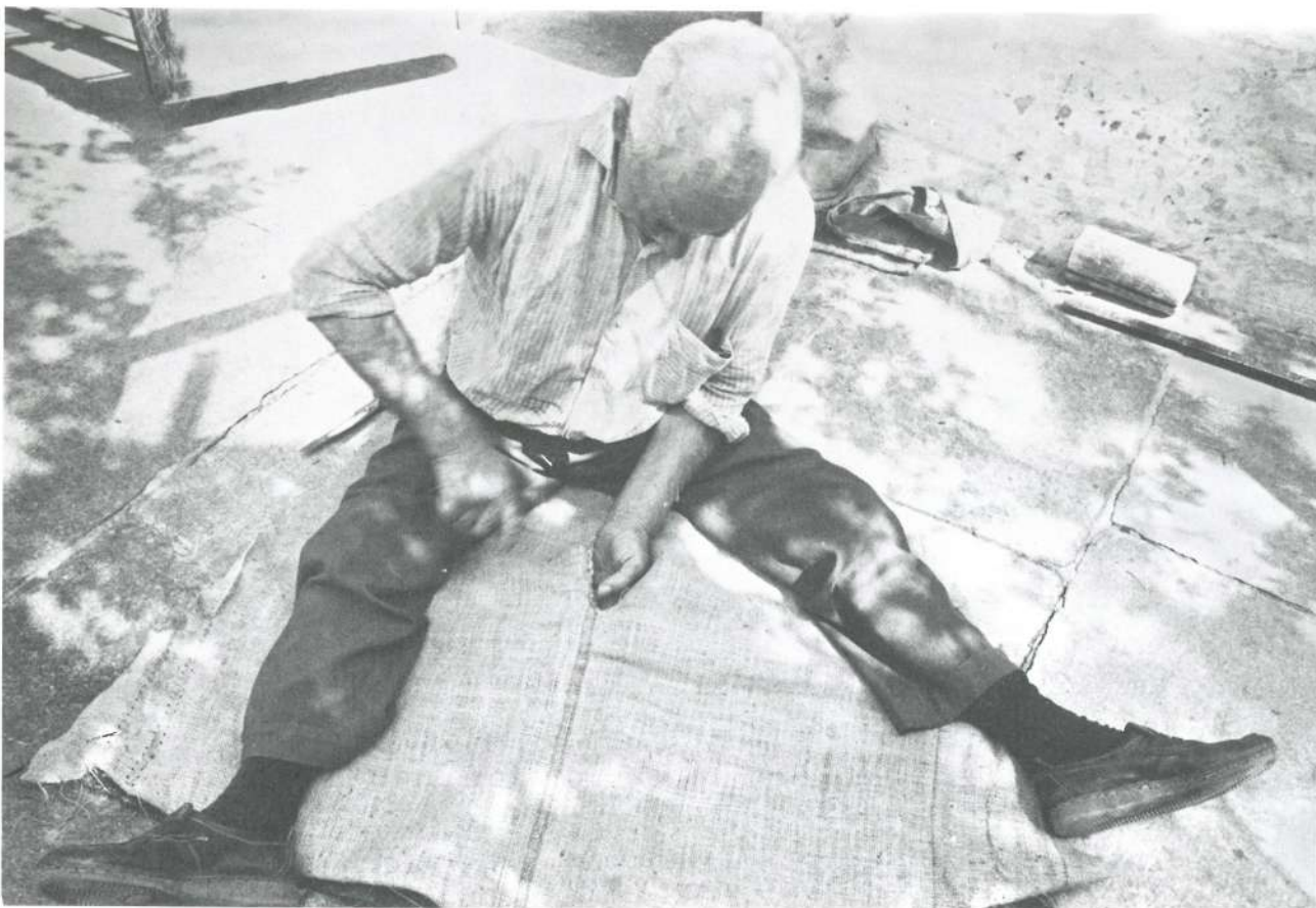
Πάνω στό σκουτί ό κύρ Βαγγέλης τοποθετεί τή φόδρα άπό τσουβάλι.
