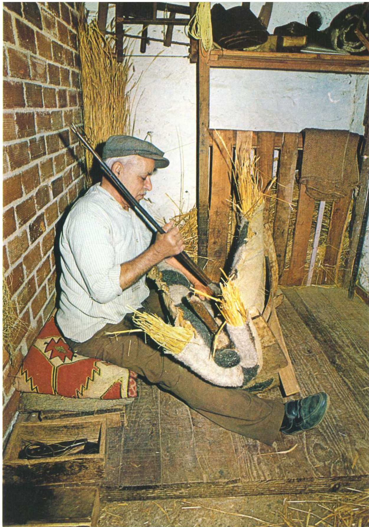
Τό πρώτο θήκισμα του στρώματος μέσα στο ξυλίκι.
