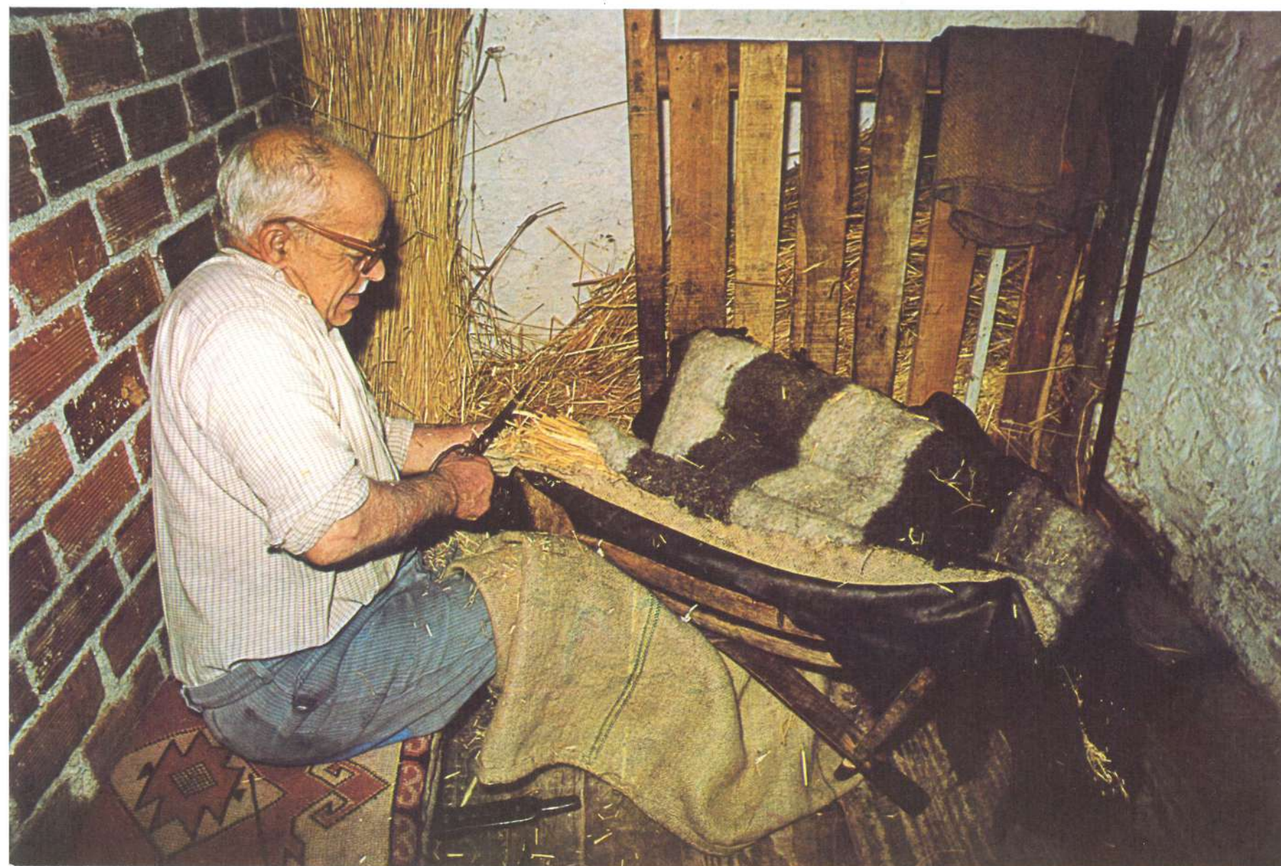
Ο σαμαράς διορθώνει τις γωνίες του στρώματος.
