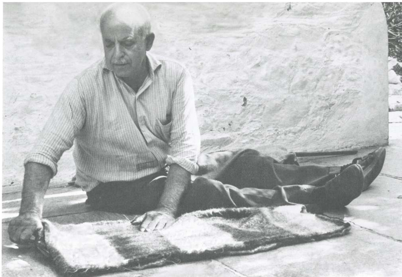
Ο σαμαράς κόβει το σκουτί γιά τό στρώμα σύμφωνα μέ τά μέτρα τού σκελετού.
