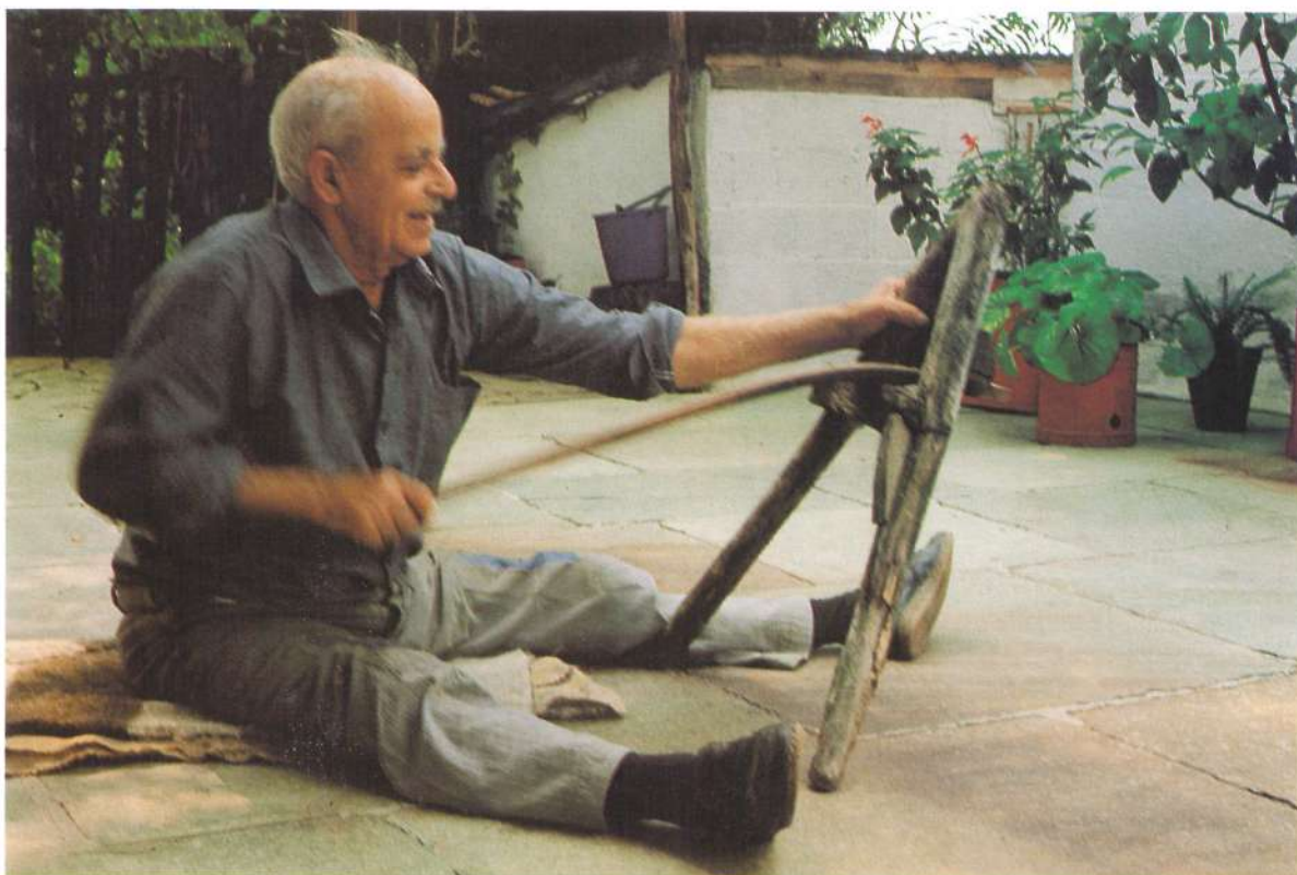
162. Ο τεχνίτης χρησιμοποιεί μια μικρή σκάλα για να λυγίσει την πλαϊνή παίδα του σαμαριού. (Φωτ. 1981).
