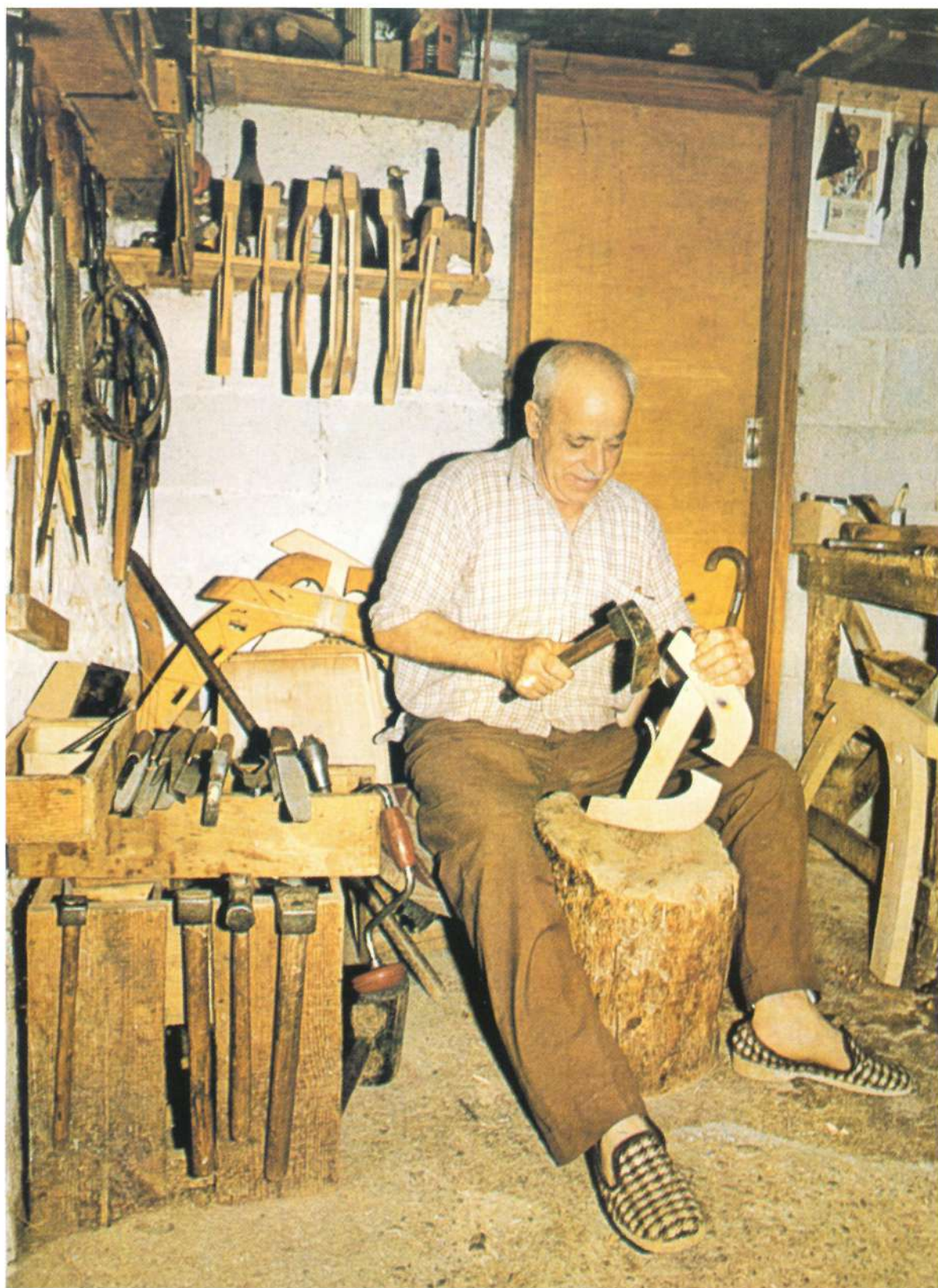
161. Ο Βαγγέλης Καταρτζής στο εργαστήρι του φτιάχνει τα κοτσάκια για τον ξύλινο σκελετό του σαμαριού. (Φωτ. 1981).
