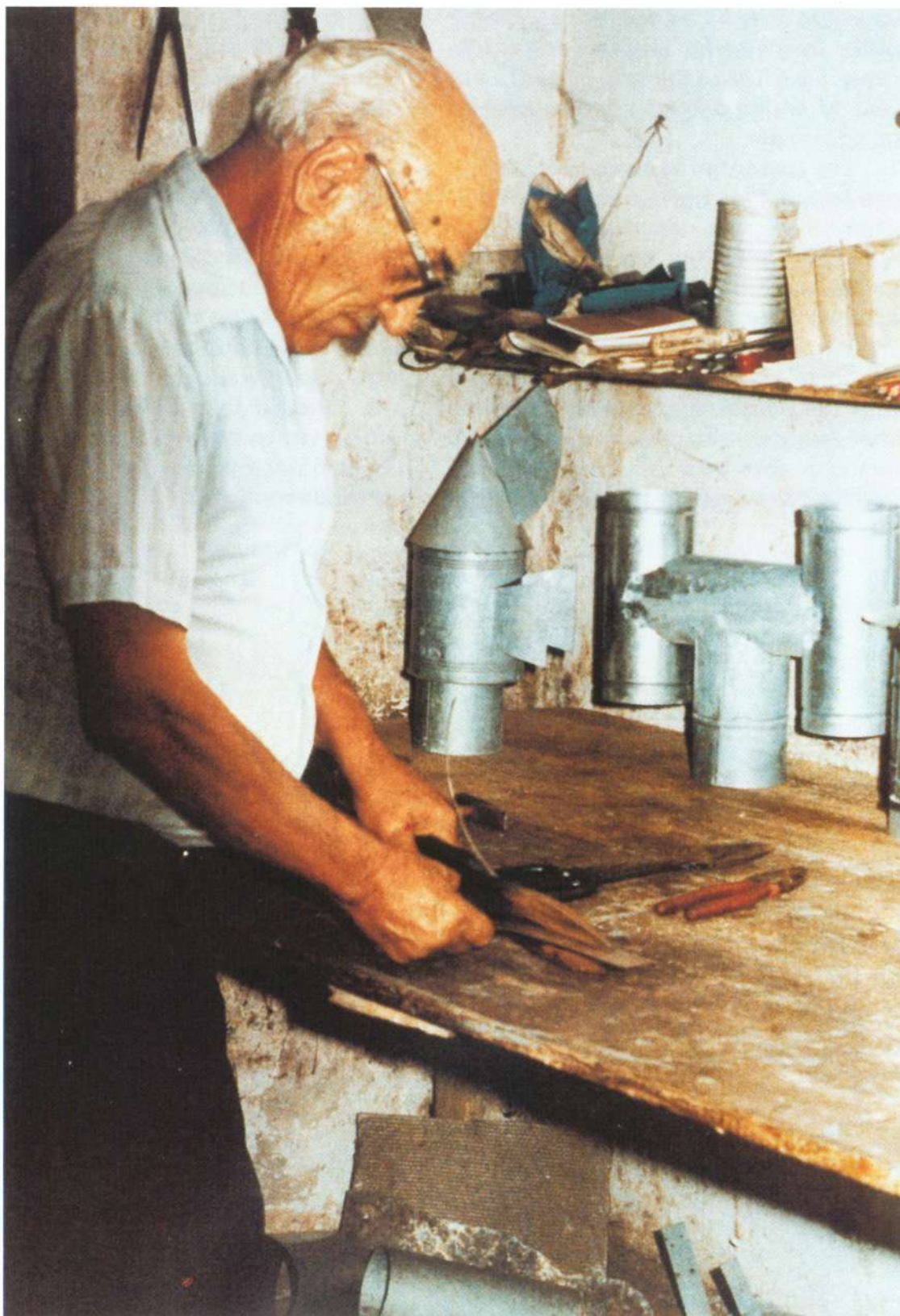
155. Ο Νίκος Τσαγκαράκης στο εργαστήρι του κόβει ένα κομμάτι λαμαρίνα με το ειδικό ψαλίδι. (Φωτ. 1986).
